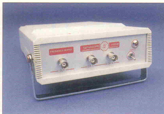
Bild 1. Das HS508 von TiePie wird als externes Gerät am Druckerport angeschlossen.
